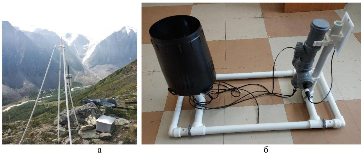
Рисунок 1. Автономные станции мониторинга: измеритель высоты снежного покрова (а); измеритель жидких осадков (б).
