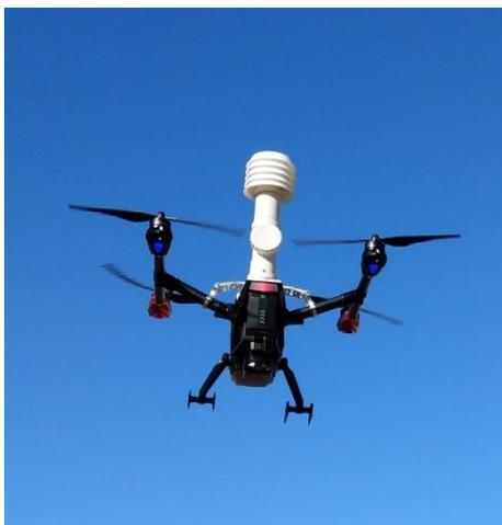
Рисунок 3. Беспилотный измеритель метеорологических характеристик (БИМ).
