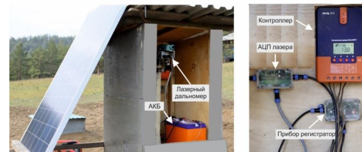
Наземная часть деформометрической станции
