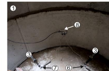
Подземная часть: схема датчиков деформации (А) и фото строительства бункера (Б-В)
