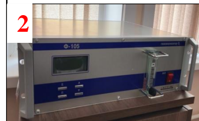
Автоматическая непрерывная регистрация газовых примесей: (SO 2 , NO, /NO 2 , O 3 , CO, Hg) (1);
