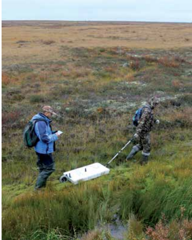
Д.А. Каверин и Н.Ю. Факашук выполняют георадиолокационное зондирование торфяника. Фото Е.А. Бабкиной
