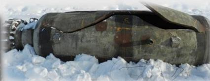
Натурные испытания сосудов давления и труб в условиях низких климатических температур, 1970-1980-е г.г. В результате этих испытаний были сформулированы требования по хладостойкости и вязкости разрушения для материалов магистральных трубопроводов Севера в виде ГОСТов и СНиПов. По данным требованиям построен самый северный газопровод Кысыл-Сыр-Якутск, который эксплуатируется до сих пор.
