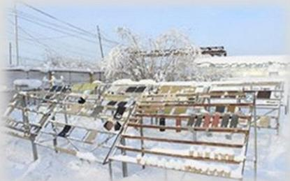
Низкотемпературные натурные испытания материалов авиационной промышленности. Испытания строительных и композитных материалов, выдача заключений по теплофизическим свойствам. Климатические испытания новых сварочных технологий и сварочных аппаратов. Температурный мониторинг узлов и деталей японских автомобилей в зимний период.
