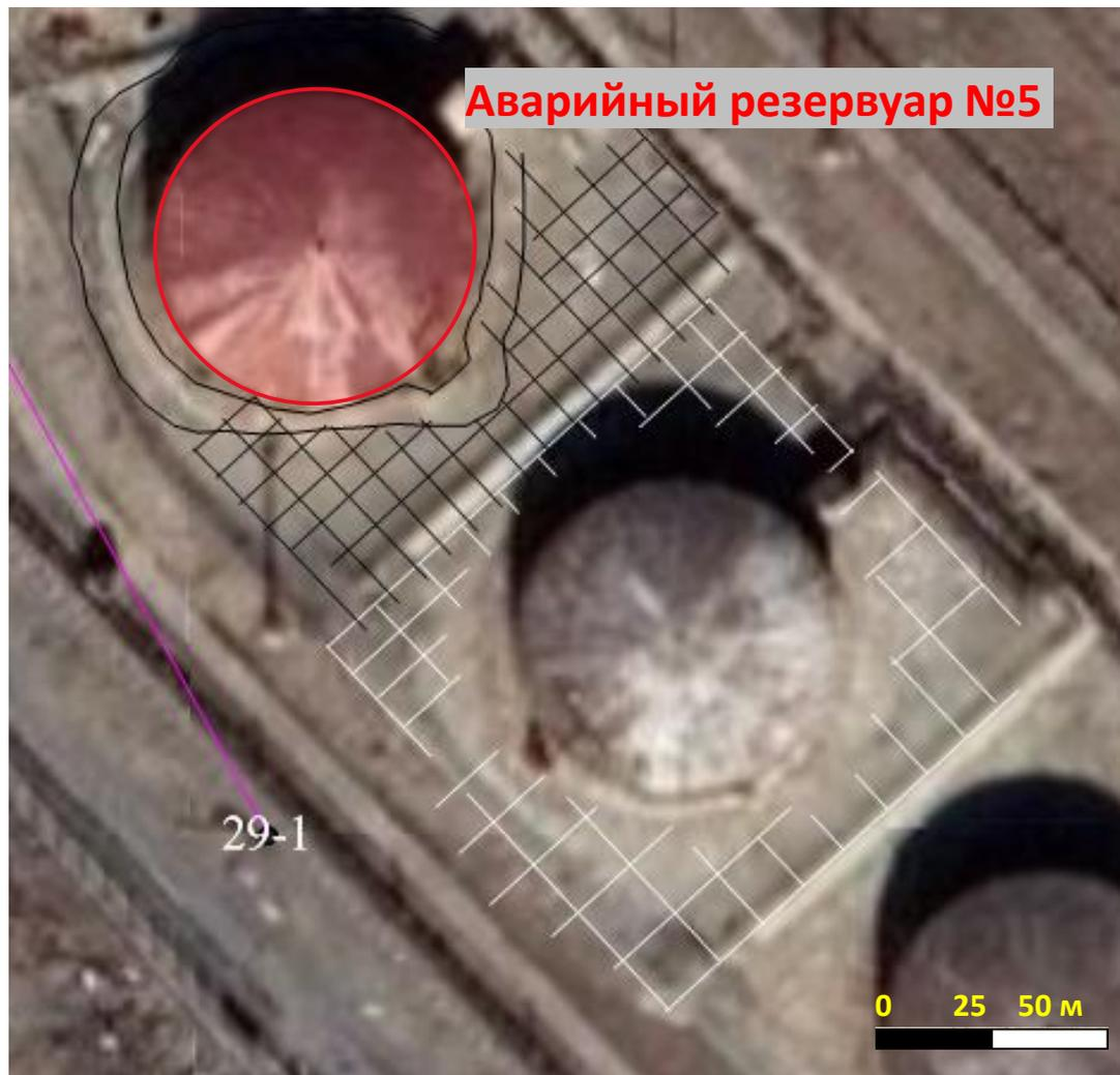
Работы выполнялись геофизическими методами по комбинированной сети параллельных профилей для обеспечения максимальной разрешающей способности. Расстояние между профилями варьировалось от 5 до 7 метров
