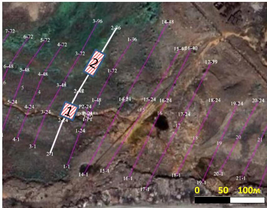
В месте зоны №1 находится основное русло стока дизельного топлива. На геоэлектрическом разрезе он выделяется интенсивной проводящей аномалией сопротивлением 100-200 Ом·м. Для сравнения, на разрезе под номером 2 выделена зона фильтрации не загрязненных вод. Подобно зоне фильтрации №1 она также обладает малыми значениями УЭС, однако они на порядок выше: от 1200 до 2000 Ом·м.
