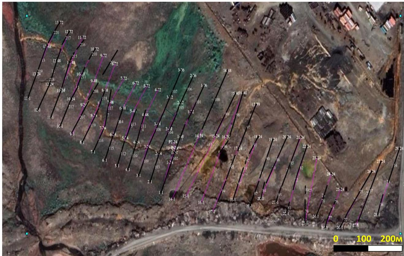
Исследования основного русла стока дизельного топлива проводились по сети параллельных профилей, удаленных друг от друга на расстоянии 25 метров. Совместно использовались методы электротомографии и георадиолокационных наблюдений.
